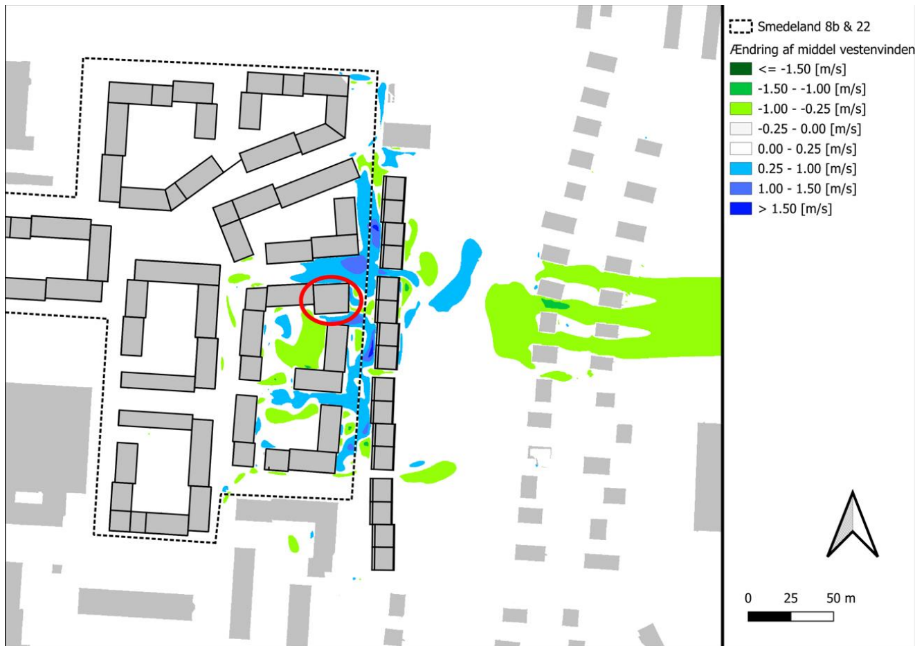
Figur 3.19. Scenarie 2 minus 3, ændring i vindhastighed 1,5 m over terræn for en baggrundsvind for en middel vestenvind. Tårn: rød cirkel. Grønne markeringer viser en reduktion i vinden som følge af højhuset, og blå markeringer viser en forøgelse af vinden som følge af højhuset.
