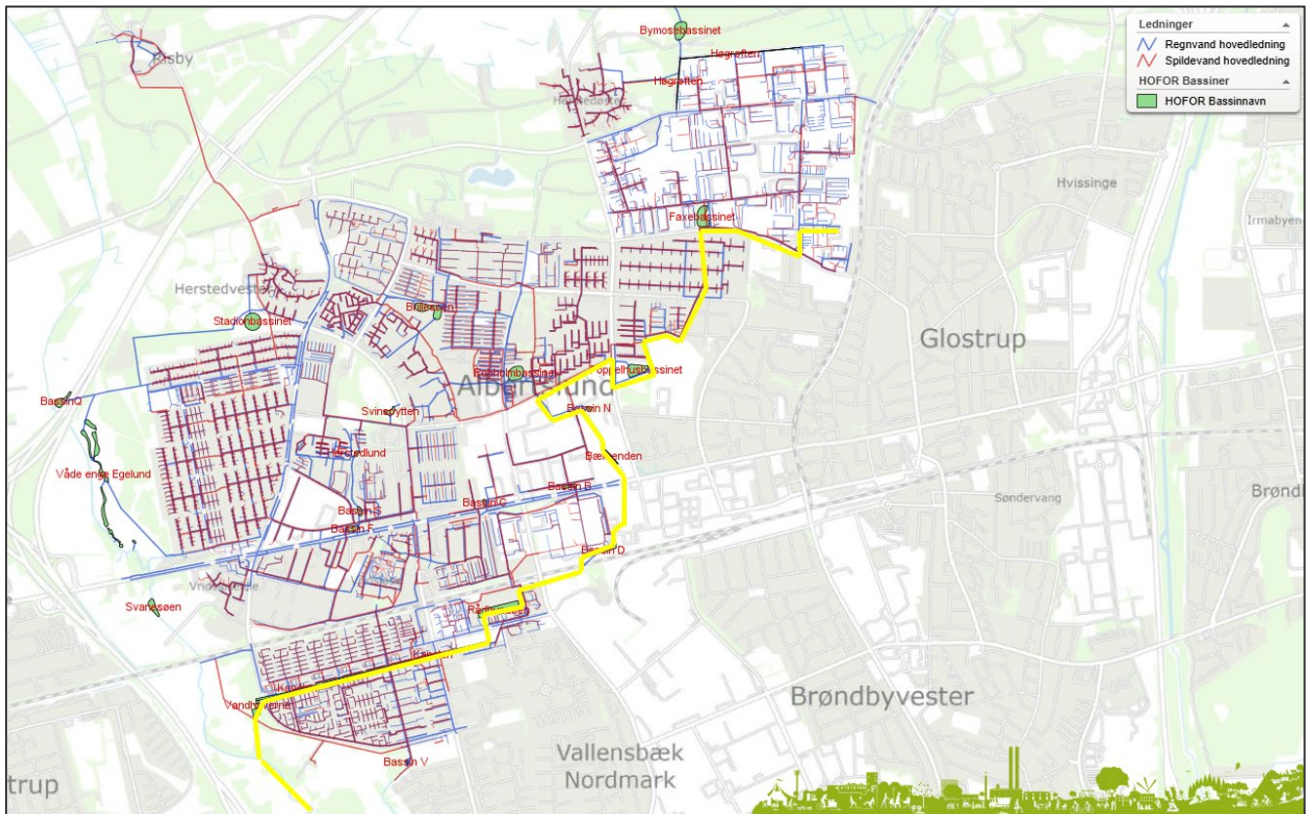
Figur 12.7: Oversigtskort over vandets vej fra planområdet til sammenløb med Store Vejle Å. Vandets vej er indtegnet med gul. Kortudsnit fra https://kort.albertslund.dk/spatialmap .
