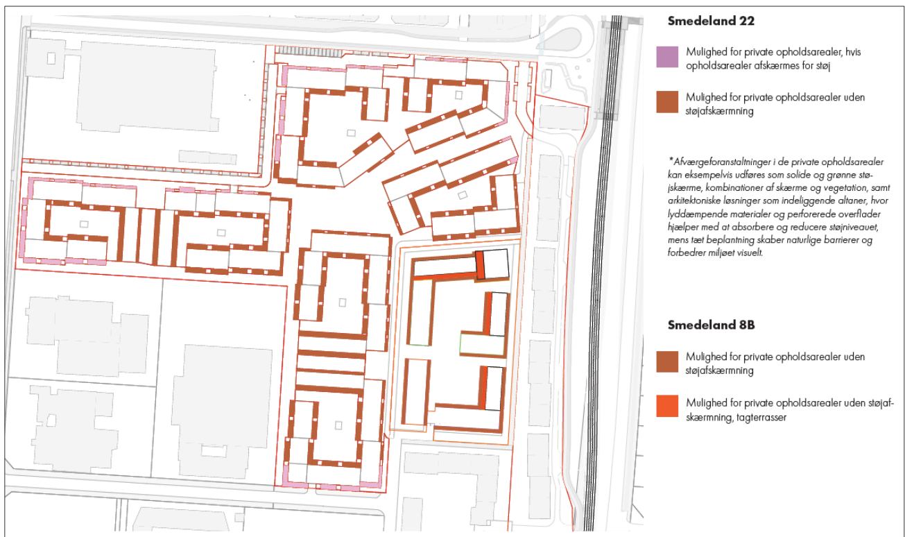
Figur 9.8: Forventede private opholdsarealer. Lyserøde felter på Smedeland 22 viser private opholdsarealer, hvor der skal etableres støjskræmning, før støjgrænserne for vejtrafikstøj kan overholdes. Illustration: Danielsen Architecture.
