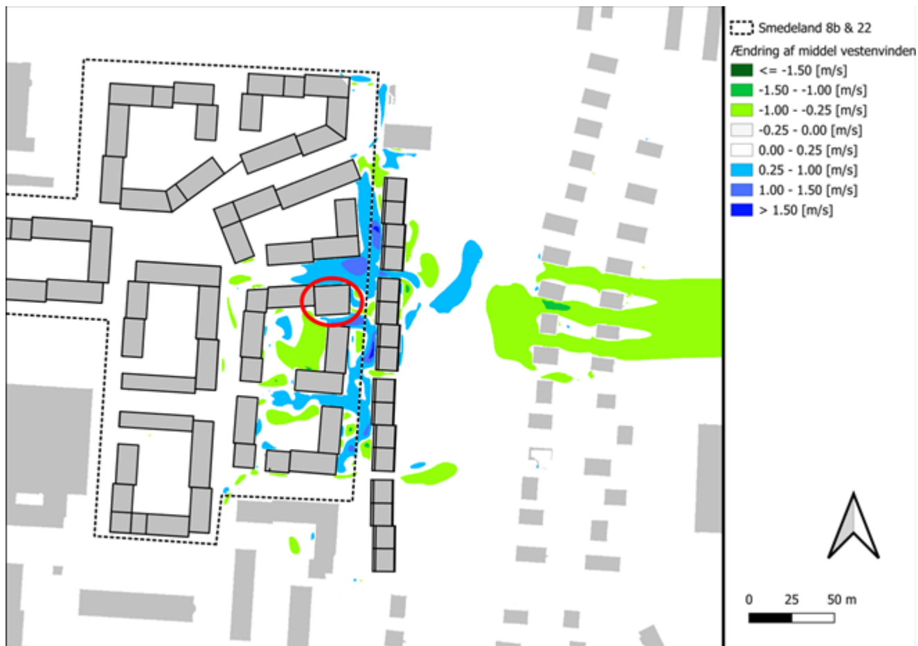
Figur 9.26: Forskellen i middelvinden fra den dominerende vindretning (vest) mellem en situation, hvor der etableres den planlagte 12 etagers bygning på Smedeland 8B og en tænkt situation, hvor denne bygning i stedet har samme højde som nabobebyggelsen. Grønne markeringer viser en reduktion i vinden som følge af tårnet, og blå markeringer viser en forøgelse af vinden som følge af tårnet.
