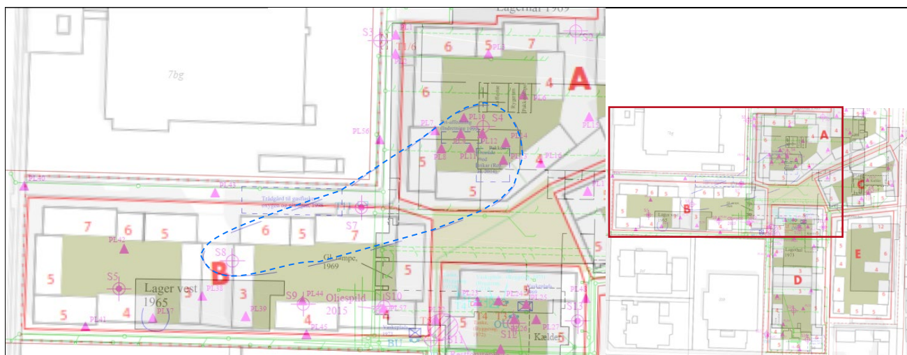
Figur 12.3: Omtrentlig placering af den i 2022 vurderede forureningsudbredelse i poreluften (blå stiplede linje) i forhold til det planlagte byggeri.
